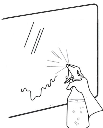
**2** Mouiller abondamment la surface de pose qui doit être préalablement bien nettoyée
