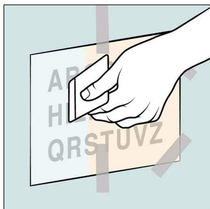
Faites adhérer la bande d'application sur la superficie au fur et à mesure avec l'aide d'une spatule ou avec une carte de crédit
