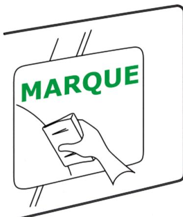
**4** Positionner l'adhésif précisément sur la surface de pose et chasser l'eau et l'air avec une raclette à vitre
